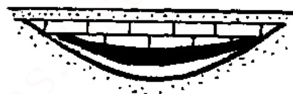
图 4.6 西伊利诺斯煤层厚度局部变化和围岩的关系示意图 (据 Wanless)
