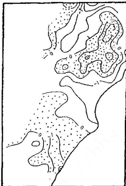
图 7.8 沃拉拉煤层二次厚度残差图
