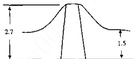
图 4.1 利用树桩测定压实比示意
