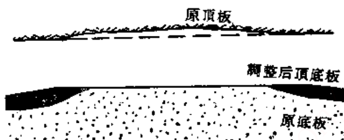
图 133 顶底板的调整
