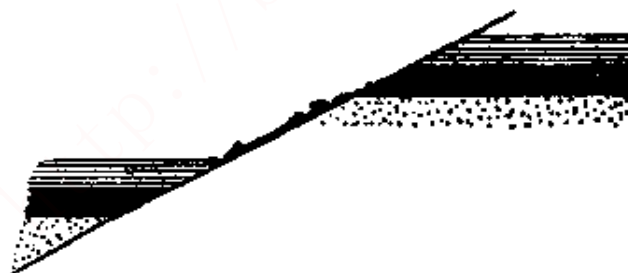
图 23 根据煤线推断煤层
