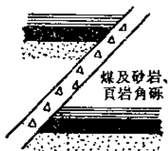
图 22 根据断层角砾推断断层
