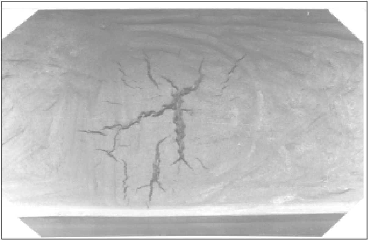
图 4-22 单向无限伸展(侧向固定)模拟——顶面出现短轴方向裂 42 缝
