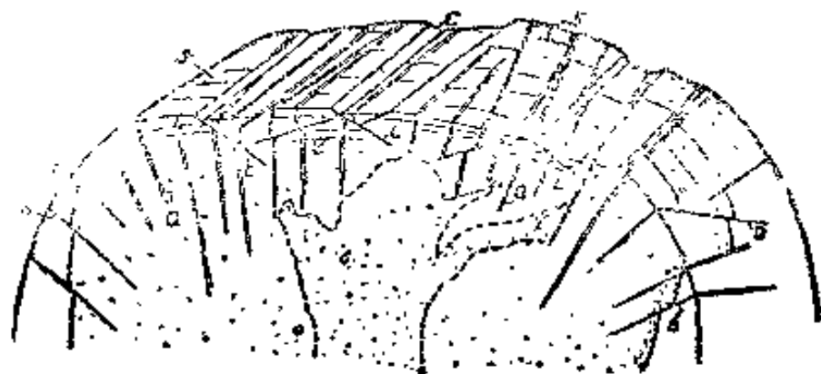
圖 30. 有凝結初期的原始構造和節理構造單元的侵入岩體頂部剖面示意圖
