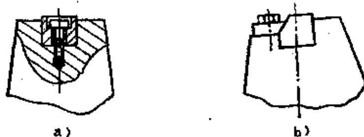
图 19 滚刀支承轴固定方式
