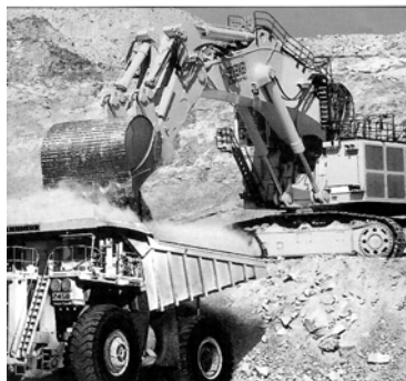
图 12-9 R996 液压挖掘机在装载作业
