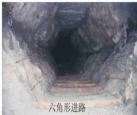
图 9-10 龙首矿六角形进路采场照片
