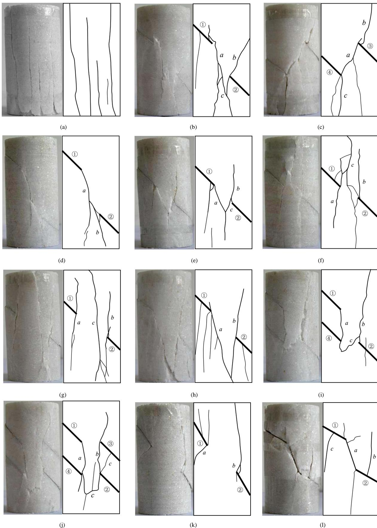
图 8 含不同几何分布的断续预制裂隙脆性大理岩单轴压缩破裂模式<sup>[32]</sup>
