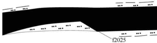
图 2 底断顶不断断层(2307 工作面) Fig. 2 Floor broken and roof unbroken fault
