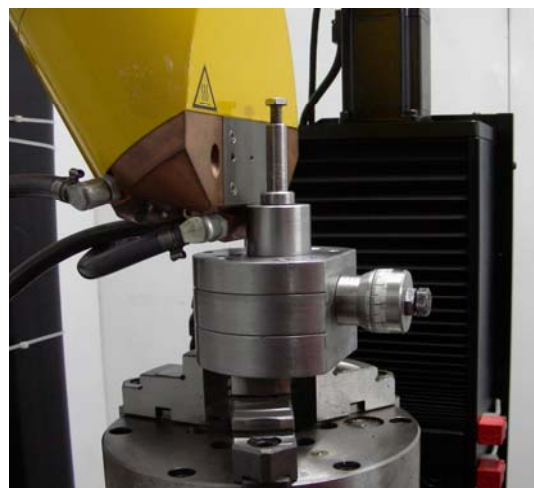
图 2 试验机与三维显微 CT 的配套耦合使用图
