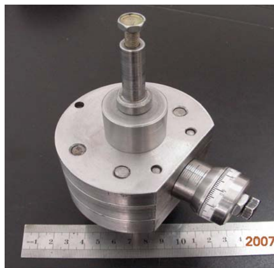
图 1 试验机的外观尺寸
