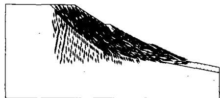
图 7 堆积土层存在时路堤的位移矢量图
