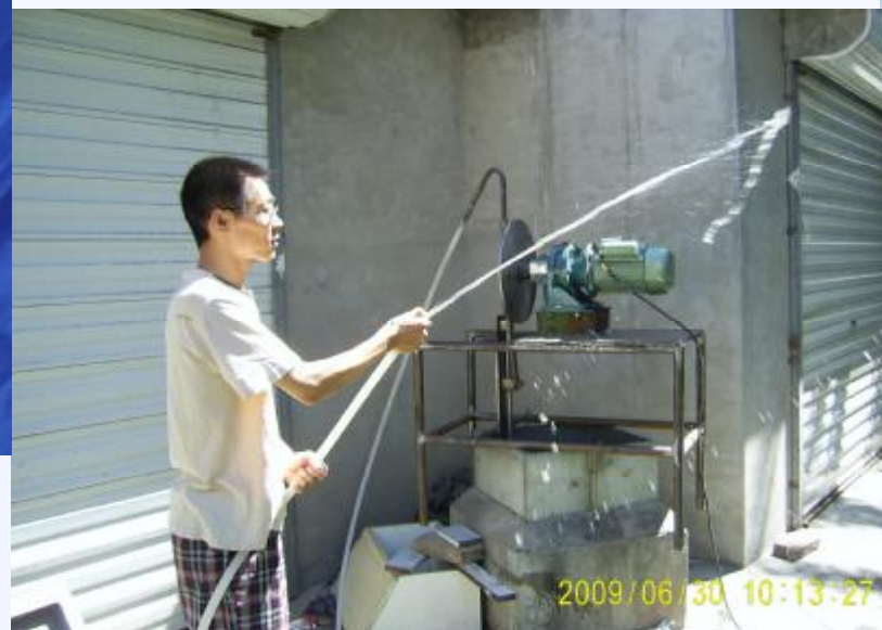
机械超深惯性泵 (深度可达100M)
