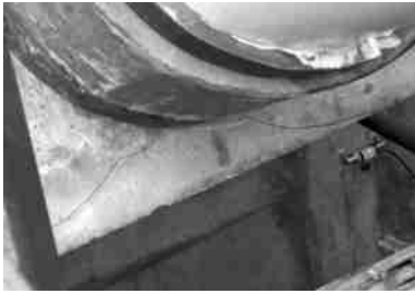
图 10 锚块下方试验加载开裂情况
