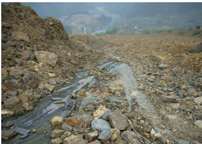
图 1-8 上部为松散土石，下部为不透水的基岩，而且基岩层面向外倾斜，降雨入渗到达基岩受阻，上部松散土石滑坡（万州铁峰乡，2004. 9. 5）
