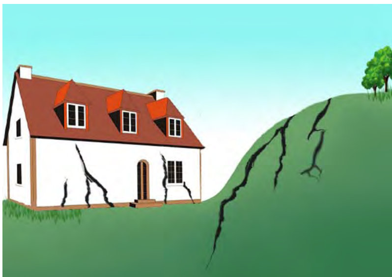
图 2-2 斜坡地表出现裂缝，斜坡上的建筑物墙壁也发生开裂
