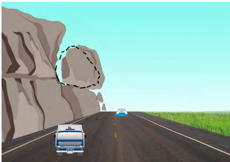
图 1-2 坠落型崩塌
