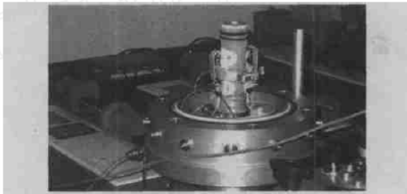
图4 安装就位的霍尔效应传感器
