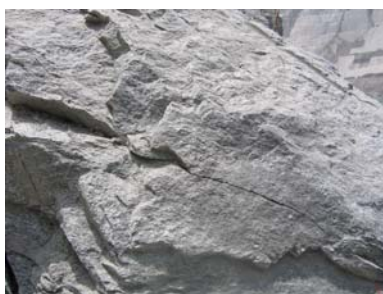
(b) 引张的新生型卸荷裂隙
