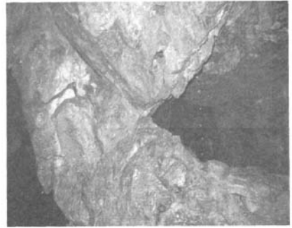
图3 630C4巷三角矿柱 (因受压而裂、剥落变小)
