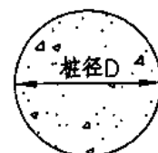
水泥粉煤灰碎石桩断面图
