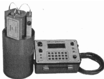
图 1 高温超导三分量磁强计
