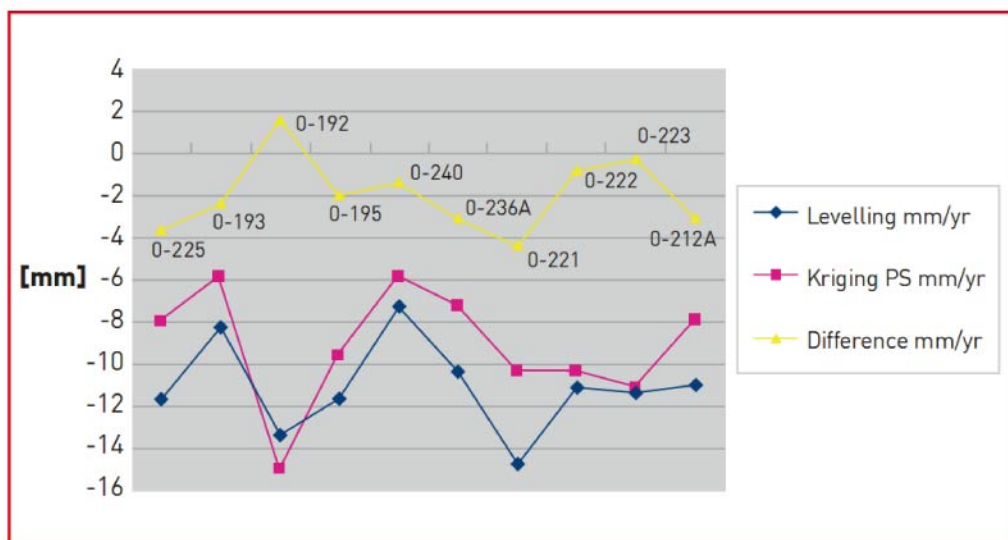
图3 上海地面PSInSAR监测 与水准测量沉降对比图
