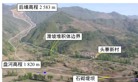
图8 头寨滑坡—土石流堆积 [27, 28]
