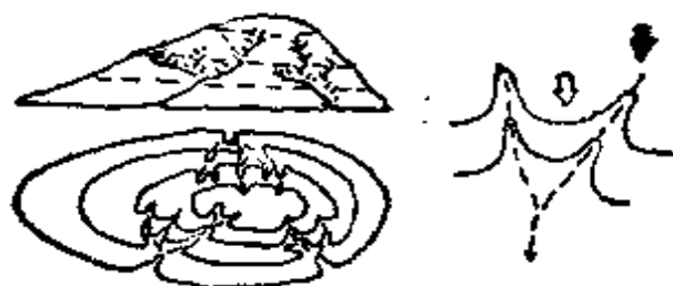
图5 沟谷等高线的V字形尖端指向山顶↓；山脊等高线的U形突起前端指向山麓↓
