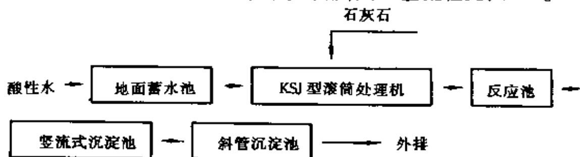
图 3-2 石灰石中和滚筒法处理酸性水工艺流程
