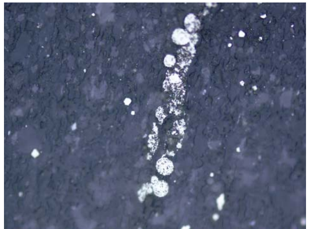
图 1 草莓状黄铁矿集合体(样号 06ZS-84), 100× (-)
