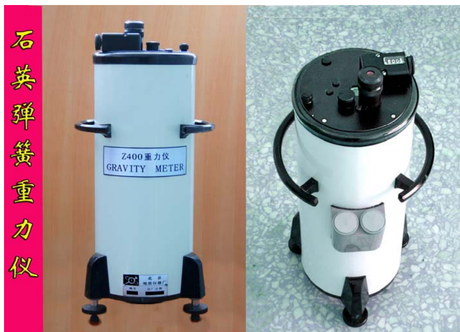
图2 石英弹簧重力仪的外形
