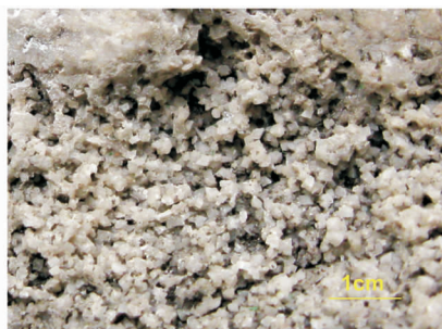
(b) 中—粗晶白云岩,晶间孔发育,塔中 243 井,5 719.05m,岩心照片
