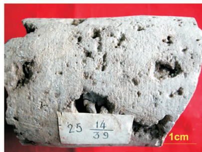
(c) 风化壳孔洞白云岩,英买 6 井,5 472m,岩心照片
