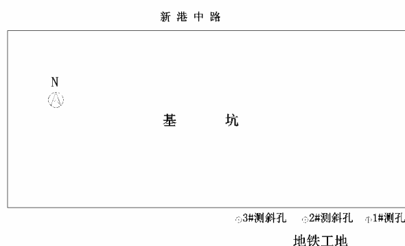
图1 基坑及测斜孔位置示意图
