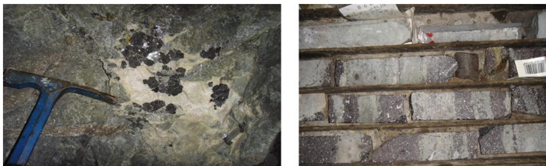
图6 黑水沟—大树脚区96号、94号矿体中的锌铜矿化特征
