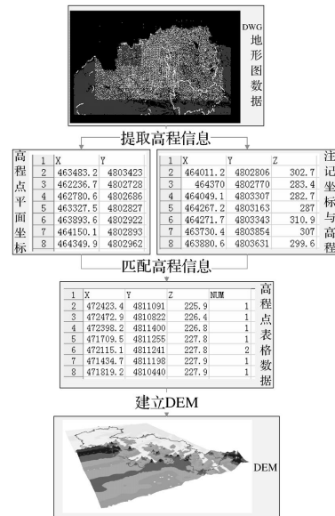
图 3 基于 DWG 数据建立 DEM 流程
