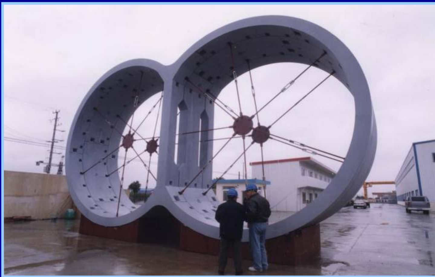
双圆盾构隧道管片
