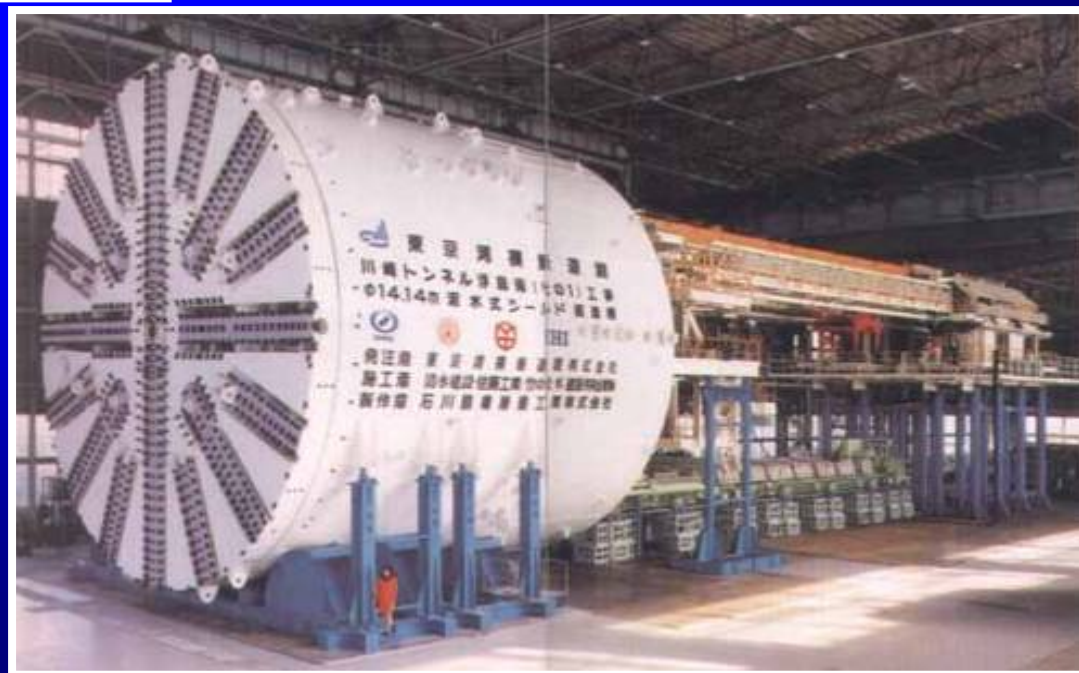
日本最新的 \Phi 14.14\text{m} 泥水平衡盾构
