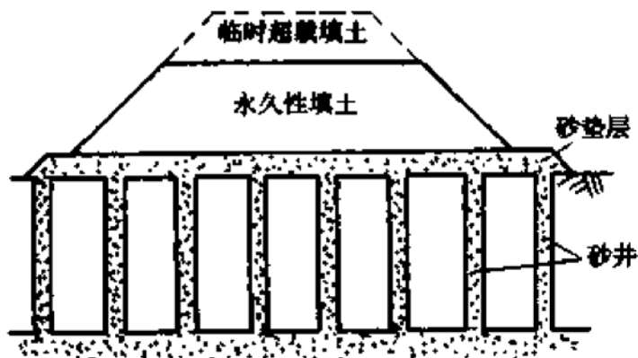
图 1-1 典型的砂井地基工程剖面图
