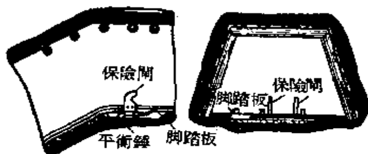
图 44 傾斜巷道上部車場平台的道卡子
