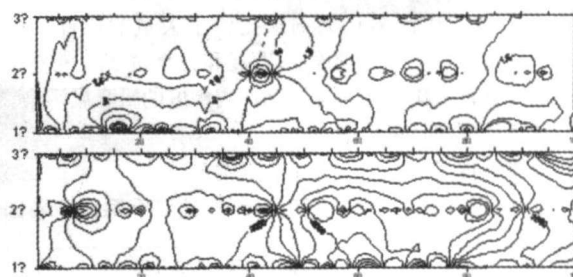
图3 永定新上坪铅锌矿区极化率、视电阻率等值线图
