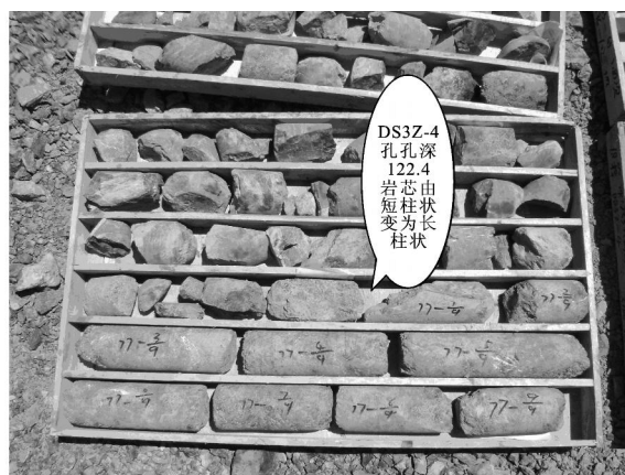
图3 隧道洞身物探“断层”两深钻孔不同深度的岩心对比
