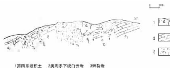
1第四系坡积土 2奥陶系下统白云岩 3碎裂岩
