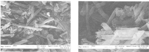
图2 漳州龙文高岭土325目精矿的SEM照片 左-2万倍;右-5万倍
