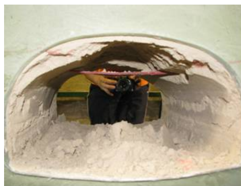
(b) 拱顶进一步塌落,伴随两侧拱腰处开始掉渣
