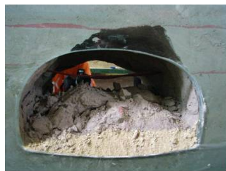
(d) 围岩出现明显破坏,拱顶小范围塌落
