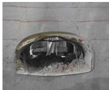
(c) 围岩松动范围扩大,拱顶出现裂缝
