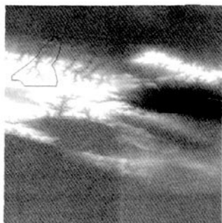
图1 用赋高程值地形线生成的 TIN
