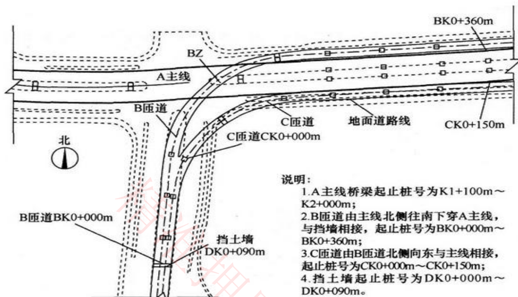
图3 桥梁总平面布置示意图
