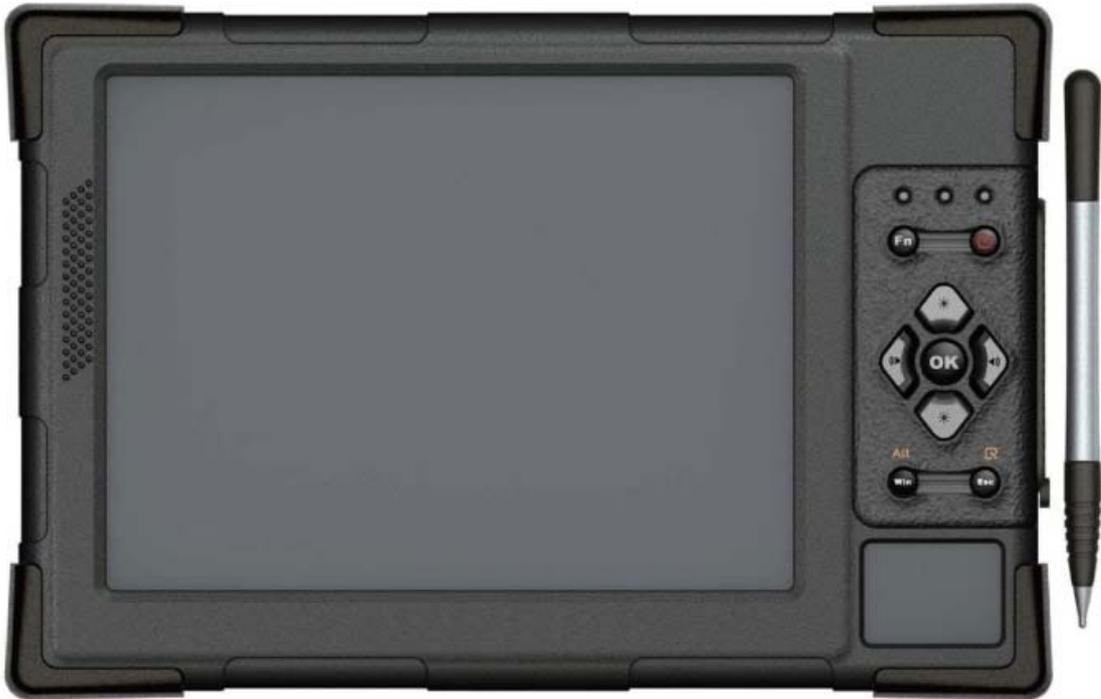
TH500 野外数据采集仪采用了 MARVELL 低功耗工业级 CPU XScale PXA270 和 Microsoft WinCE5.0 的操作系统，并且 IP65 等级进行的密封已经达到抗震防水工业等级标准。TH500 配有可更换的 4000MAH 8.4V 锂聚合物电池，可以在全天候苛刻环境下连续工作 10—20 个小时，适合固体矿产测绘和大比例尺绘图工作。TH500 的大屏幕触屏和小书写板配合使用，更方便野外工作者的绘图与手写操作，并且可根据客户需求，对 GPS、WIFI、GPRS、CDMA 等无线通讯系统进行功能的组合扩展。TH500 是我国目前唯一一款适合野外强光下使用的半透半反式液晶平版手持电脑。
