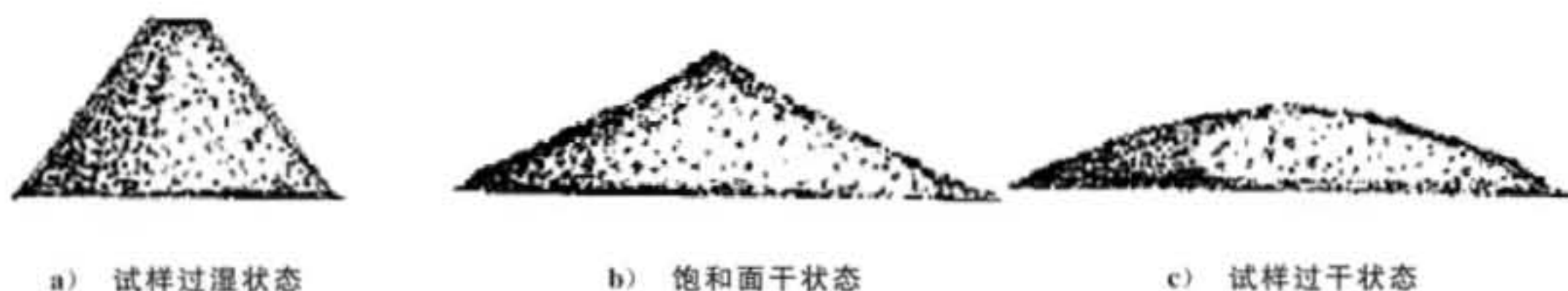
图4 天然砂饱和面干状态示意图
