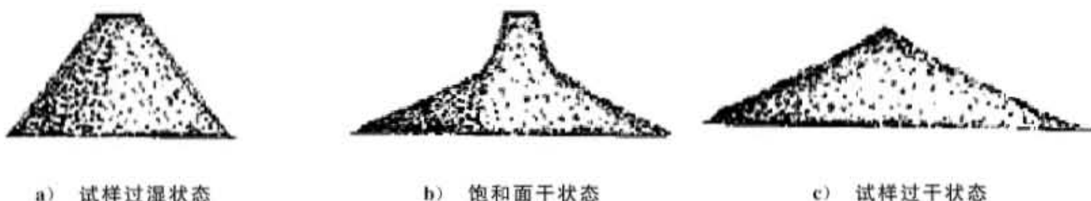
图5 机制砂饱和面干状态示意图
