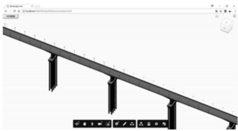
图3 轻量化BIM桥梁在浏览器显示 将BIM模型轻量化后进行导入,再布设传感器,实现所需的功能,再利用Hbuilder软件查看设计效果,本次设计上位机制作的操作菜单为:
