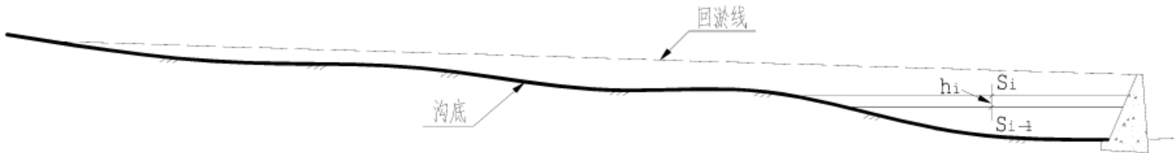
图 F.1 用等高线法计算拦挡坝库容纵断面图
