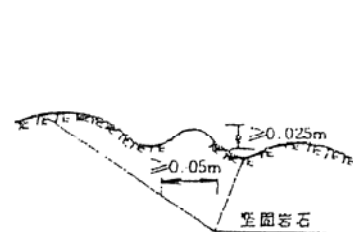
图 A.1.3 沙漠地区埋石示意 图 A.1.4 严寒地区埋石示意 图 A.1.5 修凿水准点示意
