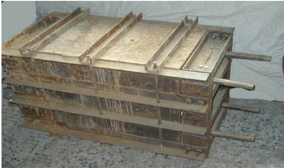
照片 1 水土压力模型试验装置
