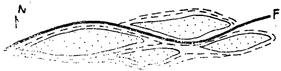
图2、沿构造透镜体边部发育的压性断面形态
