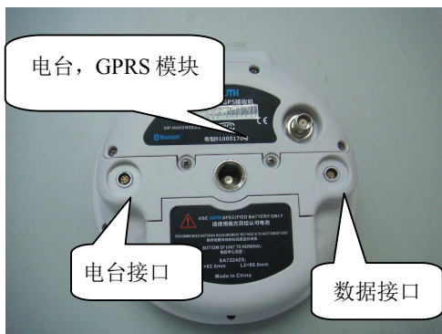
图 2-2-1 灵锐 S82-T 底部接口（移动站）
