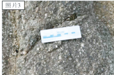
照片3: 卡拉麦里构造带南缘被动大陆边缘沉积(石英砾岩)
