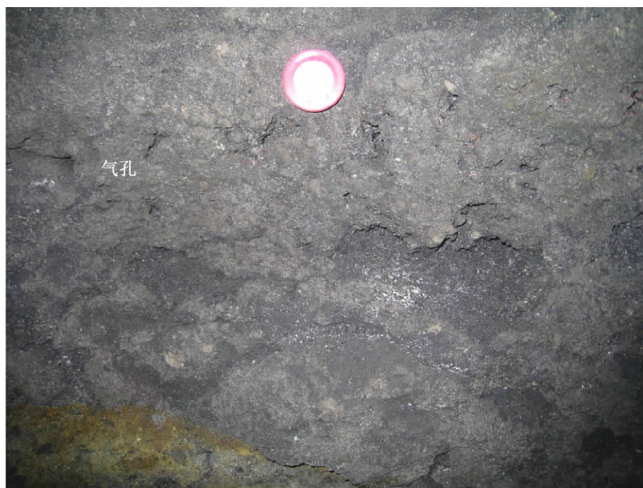
图 6 大冶铁山块状矿石中定向排列的气孔状构造
