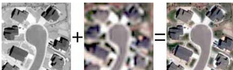
QuickBird 2.44m 多光谱影像 + QuickBird 0.61m 全色影像 = Pan-Sharpening 融合结果影像
