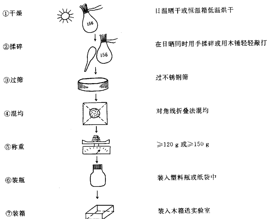
图 2 野外样品加工流程图
